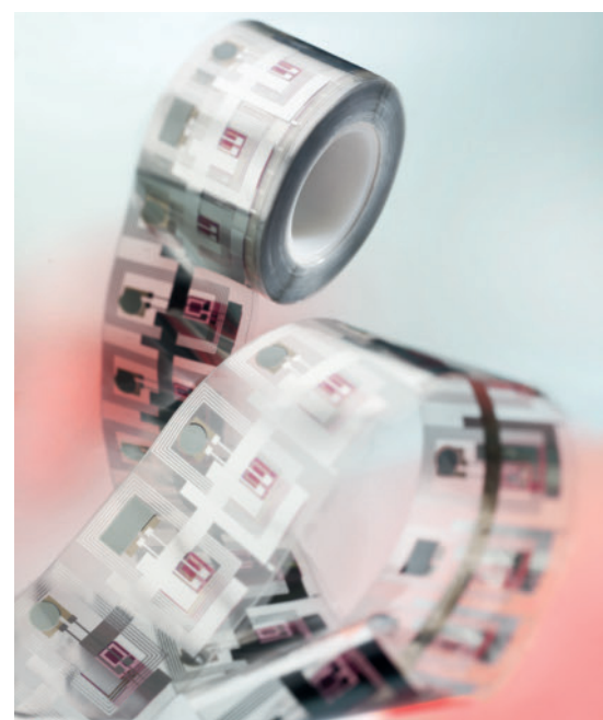
Bild 1. Gedruckte interaktive optische Etiketten (Smart Labels) von der Rolle
