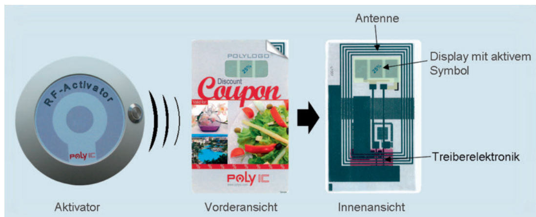
Bild 2. Ein funktionsfähiges Display besteht aus einem dünnen flexiblen Display (Mitte oben und rechts oben) mit Empfängerschaltung (rechts) und einem Aktivierungsgerät (links)
